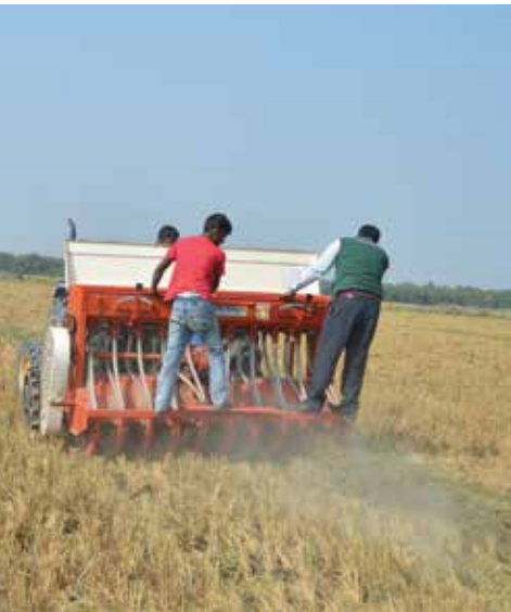
नेपाल कृषि कम्पनीले यसपालिवेदि मेज ट्रान्सप्लान्टर अर्थात् मकै रोप्ने मेशिनको परीक्षण शुरु गरेको छ । यस मेशिनले खनजोतका साथै बीउ, मल एकैसाथ छर्दछ ।
